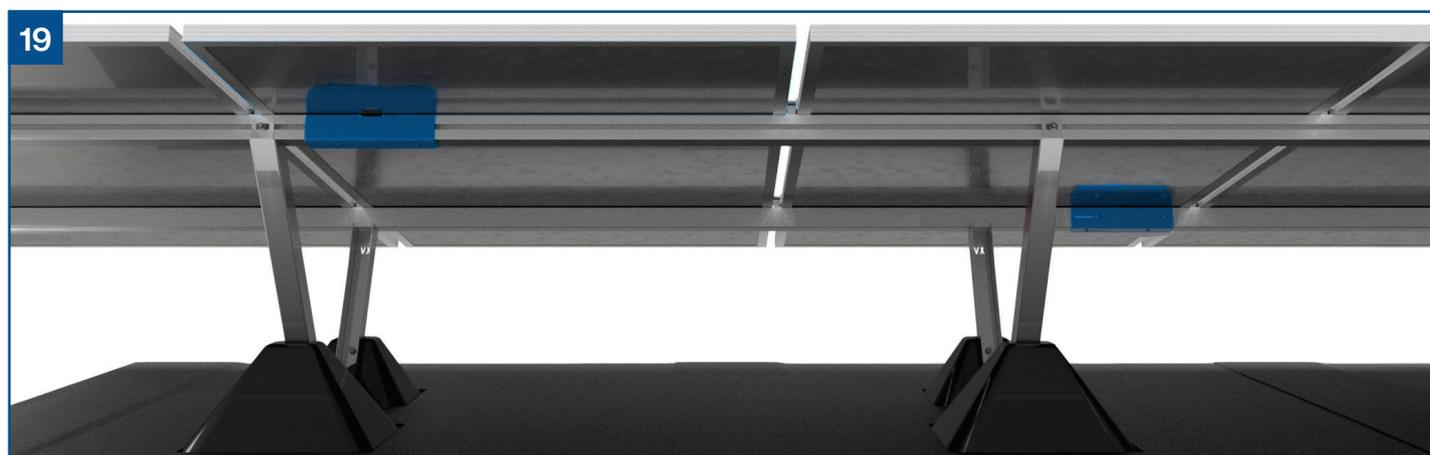
Um die konstruktive Stabilität des Systems zu gewährleisten, müssen die SOLAR - PCD Verbinder der beiden SOLAR - RAIL - 6000 mm versetzt angeordnet werden. Das heisst, es darf maximal ein RAIL-Stoss zwischen zwei SOLAR - HOLDER vorhanden sein. Von dieser Vorgabe ausgenommen sind Wärmeausdehnungs-Trennungen nach max. 24 m Profillänge.
