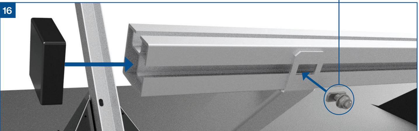
Setzen Sie die Verschlusskappen an den freien Enden auf die SOLAR - RAIL - 6000 mm. Beide SOLAR - RAIL - 6000 mm müssen mit den entsprechenden Hammerkopfschrauben an den SOLAR - HOLDER verschraubt werden.
