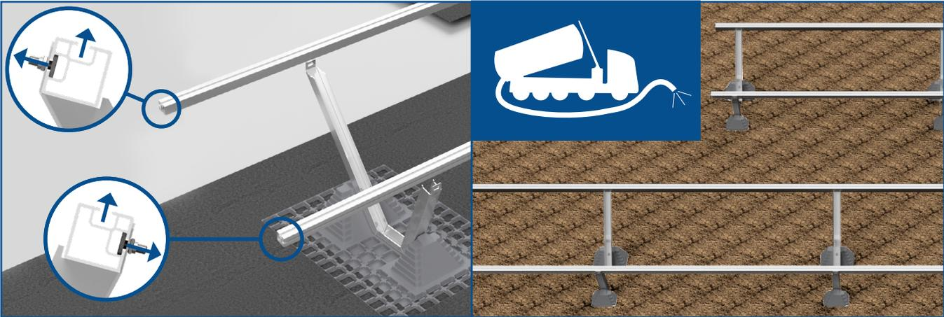
GreenSol 2.0-RAIL auf die GreenSol 2.0-HOLDER montieren und anschliessend das Begrünungssubstrat auf die Dachfläche aufbringen.
